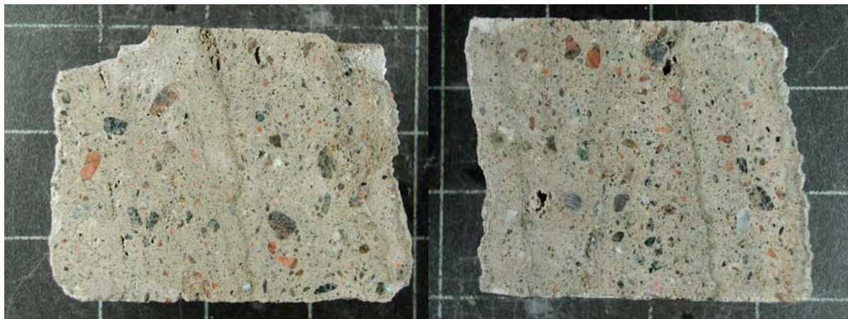
Figur 4.5. Foton av provbitar från tunneln under Göta Älv. Varje ruta 30 mm. Till höger sprutbetongytan och till vänster kontaktytan mot berg. Man kan observera en distinkt bandning antagligen orsakat av sprutlager. Naturballast 0-8 mm.
