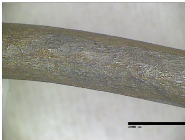
Figur 5.5. Brudaremossen: Tråd 18, korrosionshastighet 1 µm/år
