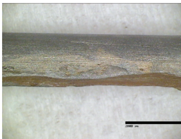
Bild 5.6. Tråd 39, Göta Älv: korrosionshastighet 65 µm/år
